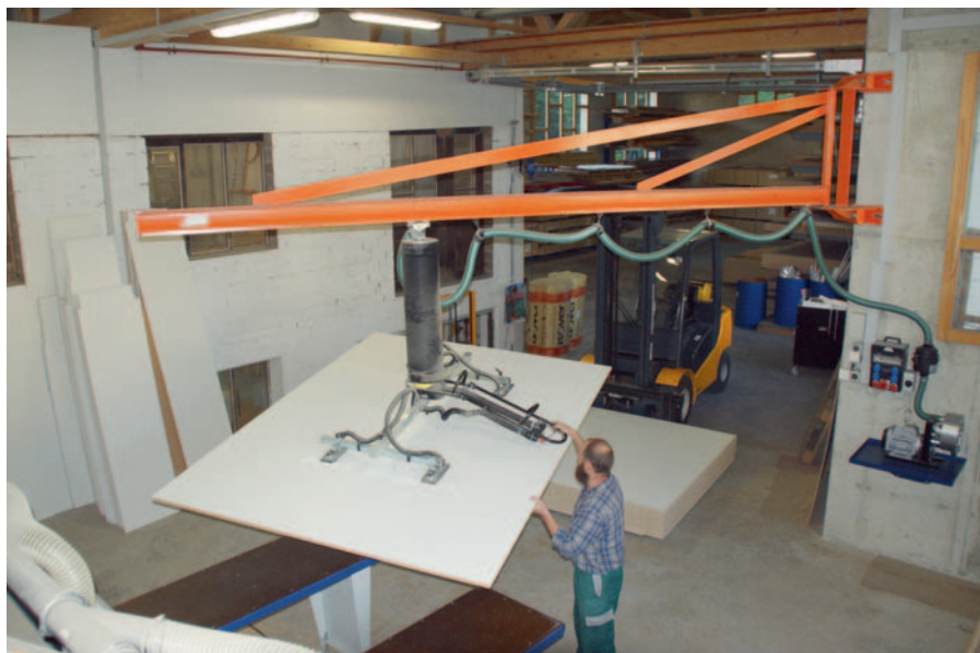
Eine sperrige Spanplatte wird mit dem Vakuumheber vom Stapel angehoben und mittels Wandschwenkkran zur Tischplattensäge transportiert. Die Bedienerperson steht hierbei stets sicher neben der Last. (Bilder: GIS)
